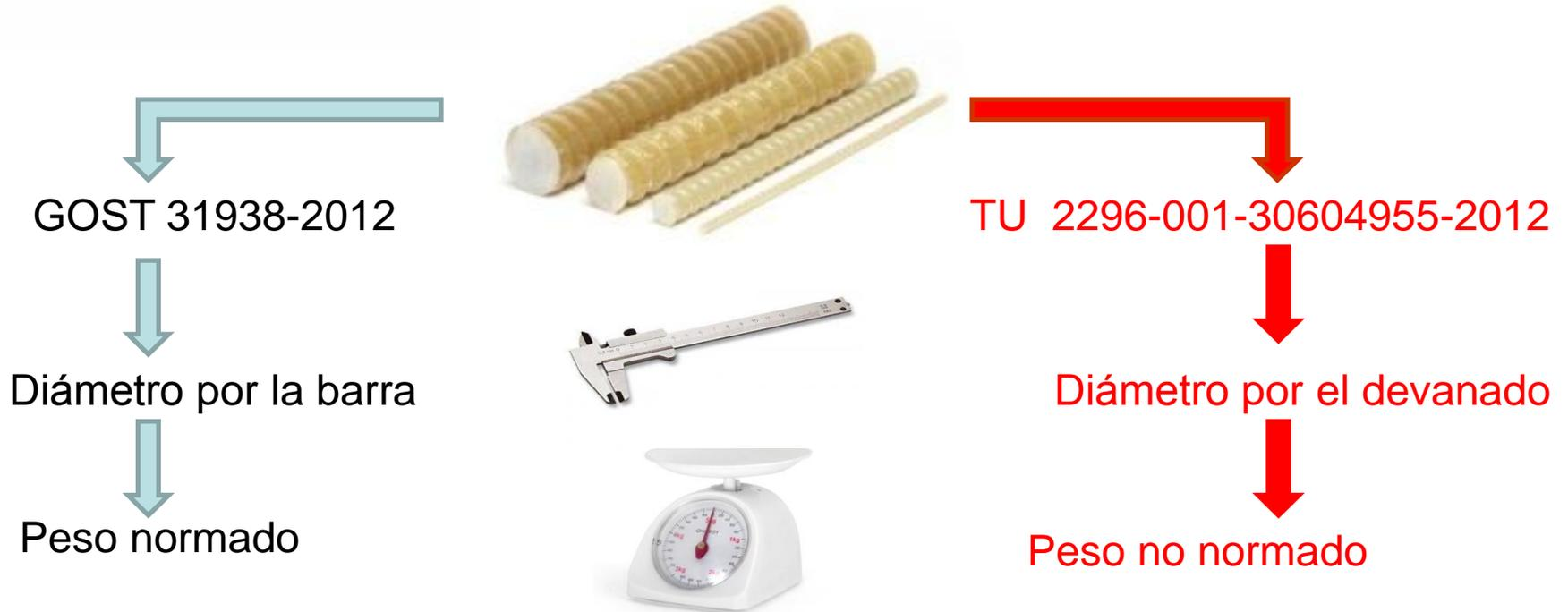
**Las especificaciones físicas de armadura según TU ceden a la armadura según GOST con los diámetros iguales declarados. Por eso es imposible calcular técnicamente correcto el reforzamiento durante el uso de armadura según TU.**
