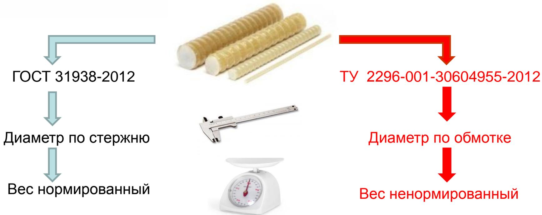
**Физические характеристики арматуры по ТУ уступают арматуре по ГОСТУ при равных заявленных диаметрах. Поэтому невозможно технически грамотно рассчитать армирование при использовании арматуры по ТУ.**
